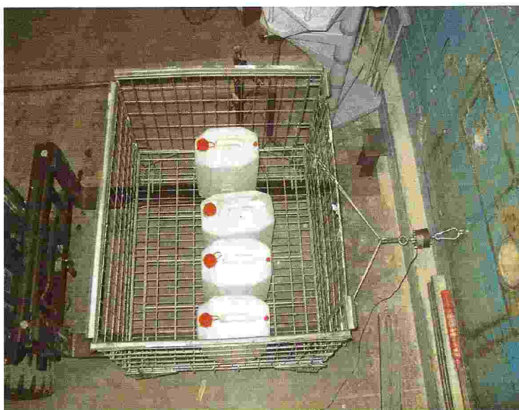
Fotografia della prova di slittamento del cestone in ferro porta merci.
